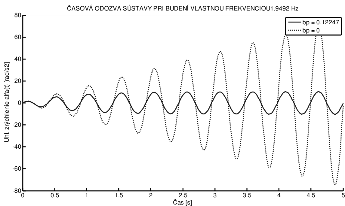
Obr. 11.36 Časová odozva zrýchlenia kmitania nosníka pri budení vlastnou frekvenciou
